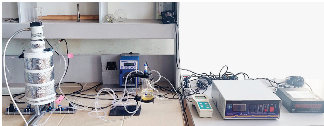
Рис. 7. Общий вид смонтированного в НИГТЦ ДВО РАН лабораторного реактора с системой контроля / регулирования параметров пульпы в процессе её УЗИ активации / Fig. 7. General view of the laboratory reactor mounted at the NIGTC FEB RAS with a system for monitoring/regulating the parameters of the pulp during its ultrasonic activation
